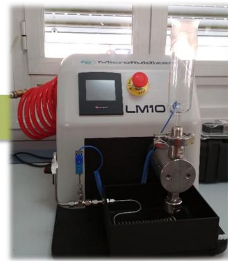
Microfluidizer Máxima Presión: 1500 bar Cámaras en forma de Z: 100 and 200 nm
