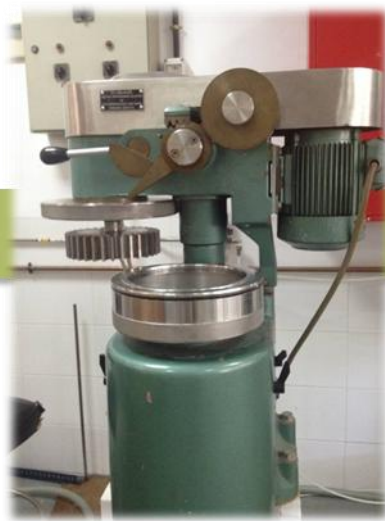
Molino PFI Desfibrilación sin cortar fibras
